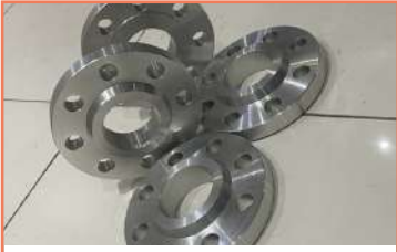
Maquinado De Bridas ( En Aluminio ) Centro De Maquinado Cnc (Vf-3ss)
