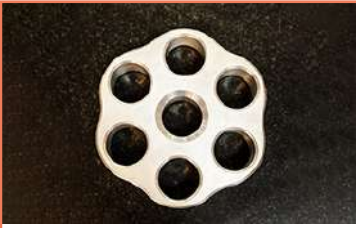
Barril En Ai304 Fresadora CNC ( XD-40A )
